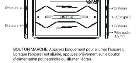
BOUTON MARCHE: Appuyez longuement pour allumer l'appareil; Lorsque l'appareil est allumé, appuyez brièvement sur le bouton d'alimentation pour éteindre ou allumer l'écran.
