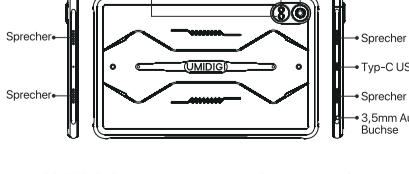
**POWER-TAS:** Lange drücken, um das Gerät einzuschalten; Wenn das Gerät eingeschaltet ist, drücken Sie kurz die Ein-/Aus-Taste, um den Bildschirm herunterzufahren oder einzuschalten.
