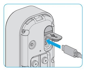
Branchez l'autre extrémité du cordon dans un bloc de charge doté d'un connecteur USB-A (non fourni).
