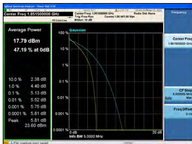
Band2 / 3MHz / Mid CH / QPSK
