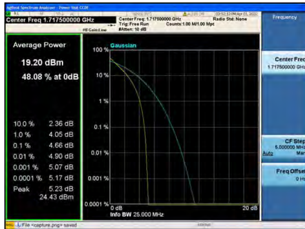
Band4 / 15MHz / Mid CH / QPSK
