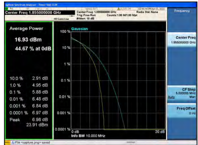
Band2 / 10MHz / Mid CH / 16QAM
