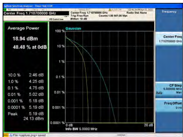
Band4 / 1.4MHz / Mid CH / QPSK
