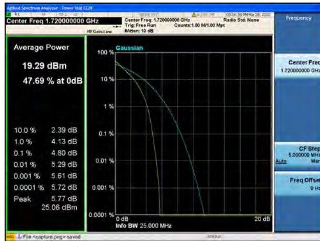
Band66 / 20MHz / Mid CH / QPSK
