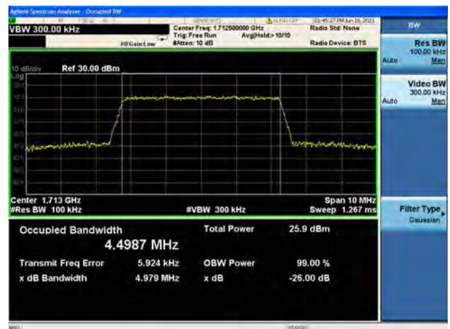
Band66 / 5MHz / Mid CH / QPSK
