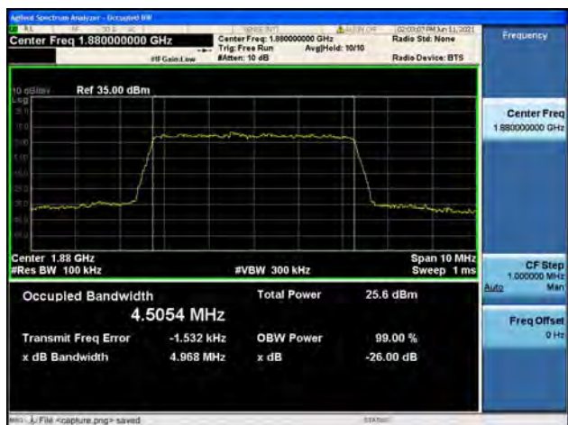
Band2 / 5MHz / Mid CH / 16QAM
