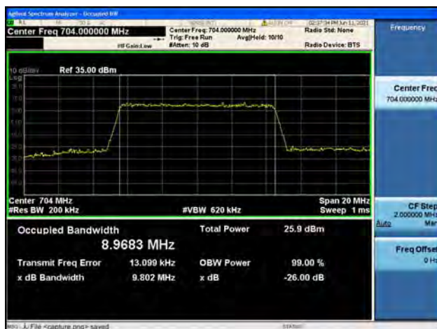
Band12 / 10MHz / Low CH / 16QAM
