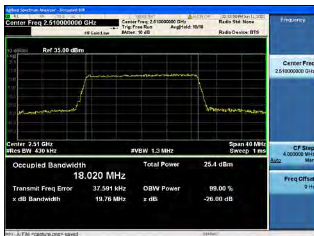
Band7 / 20MHz / Low CH / 16QAM
