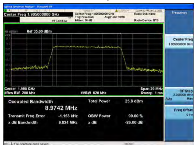
Band2 / 10MHz / High CH / 16QAM
