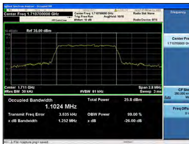
Band4 / 1.4MHz / Mid CH / QPSK
