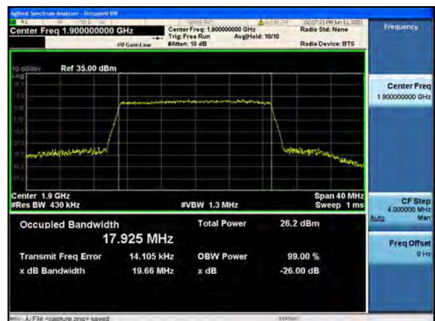
Band2 / 20MHz / High CH / 64QAM
