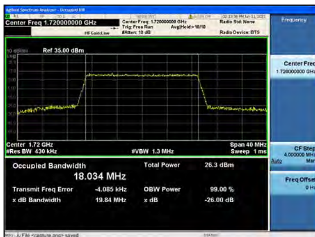
Band4 / 20MHz / Low CH / 16QAM
