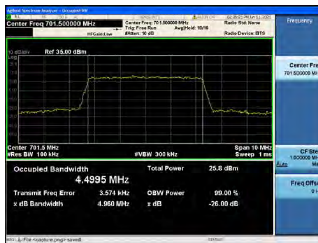
Band12 / 5MHz / Mid CH / QPSK
