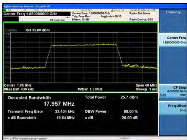
Band2 / 20MHz / Low CH / 64QAM
