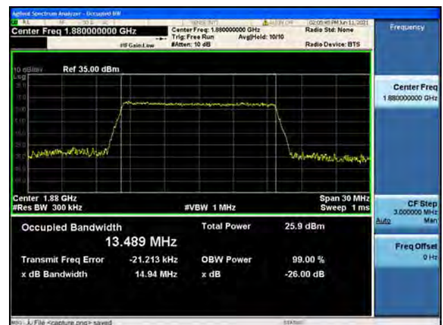
Band2 / 15MHz / Mid CH / 64QAM
