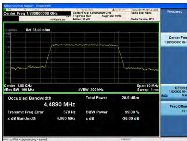
Band2 / 5MHz / Mid CH / 64QAM
