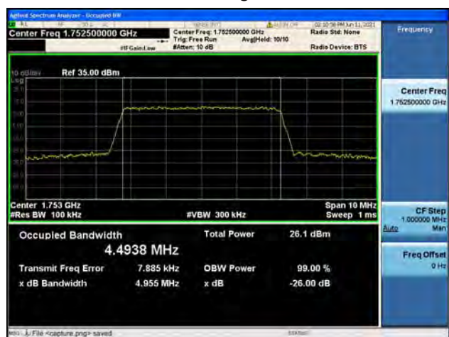
Band4 / 10MHz / Low CH / 16QAM
