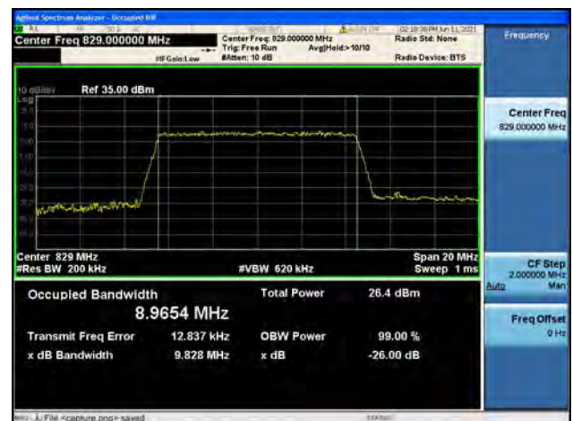
Band5 / 10MHz / Low CH / 64QAM
