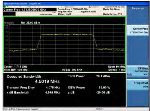
Band4 / 5MHz / Mid CH / QPSK
