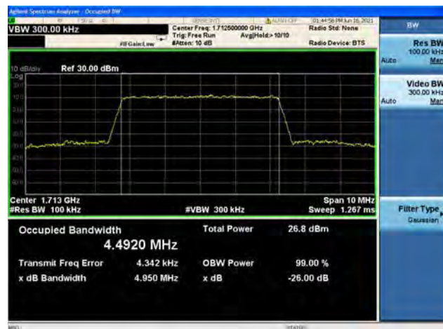
Band66 / 5MHz / Low CH / 64QAM
