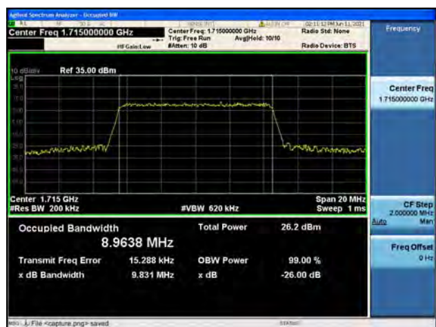
Band4 / 10MHz / Low CH / 16QAM
