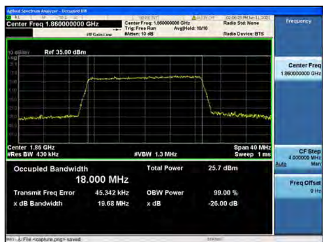
Band2 / 20MHz / Low CH / 16QAM
