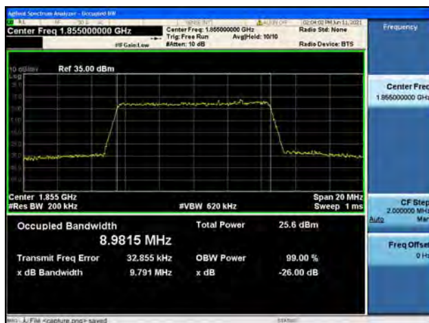
Band2 / 10MHz / Low CH / 16QAM
