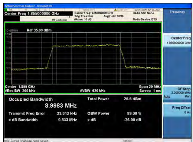
Band2 / 10MHz / Low CH / 64QAM
