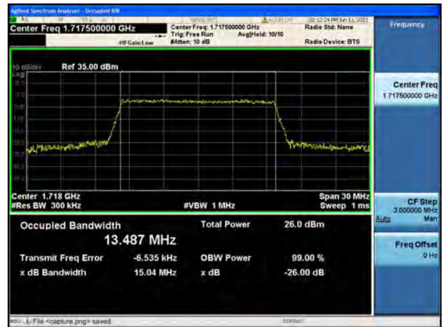
Band4 / 15MHz / Mid CH / QPSK
