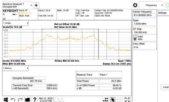
IC OBW_FSK 100Kbps _MidCH-914.9MHz
