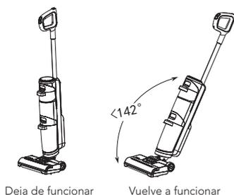
El aparato dejará de funcionar cuando se coloque en posición vertical y volverá a funcionar cuando se reclina.
