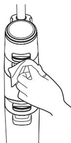
Utilice un paño para limpiar la superficie con un detergente neutro. El paño debe estar seco para evitar que entre agua en el aparato.
