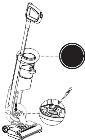
Cuando el bucle LED se ilumina en rojo, retire el depósito de agua sucia, limpie el sensor de suciedad con un paño húmedo o una herramienta de limpieza.
