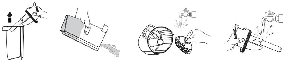
Si el filtro y el flotador se han bloqueado, enjuáguelos con agua. Quite el filtro de la tapa del depósito, extraiga el flotador y enjuague ambas piezas con agua.
