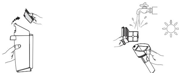
Sujete la zona rebajada de cada lado del filtro y tire hacia arriba. Enjuáguelo bajo el grifo y asegúrese de que está completamente seco antes de volver a combinarlo con la tapa del DAS.
