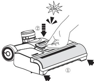
Cuando sustituya la cubierta, fjela siempre en su posición para evitar fugas.
