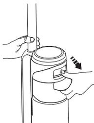
Pulse el botón de liberación del depósito de agua limpia para sacarlo del aparato.
