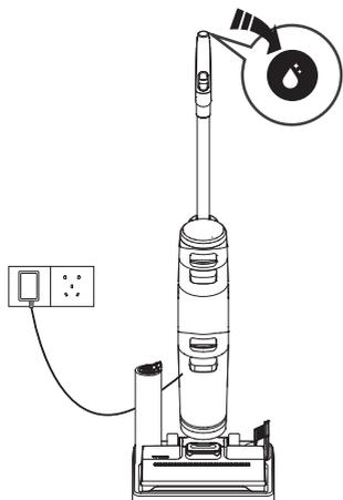
1. Coloque el aparato en la bandeja de almacenamiento y enchúfelo. Puse el botón de autolimpieza para iniciar el proceso.
