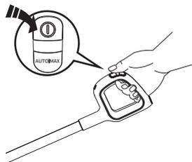
Si pulsa el botón ① el aparato se iniciará en el modo AUTO de forma predeterminada. Púlselo de nuevo para apagar el aparato. Para cambiar entre los modos AUTO y MAX, pulse el botón **AUTO/MAX**.
