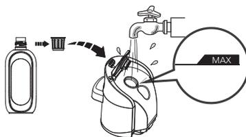
Abra el tapón del depósito y llénelo con agua del grifo hasta la línea de nivel máximo. Cuando sea necesario realizar una limpieza a fondo, añada un tapón de solución al DAL y cierre bien el tapón.
