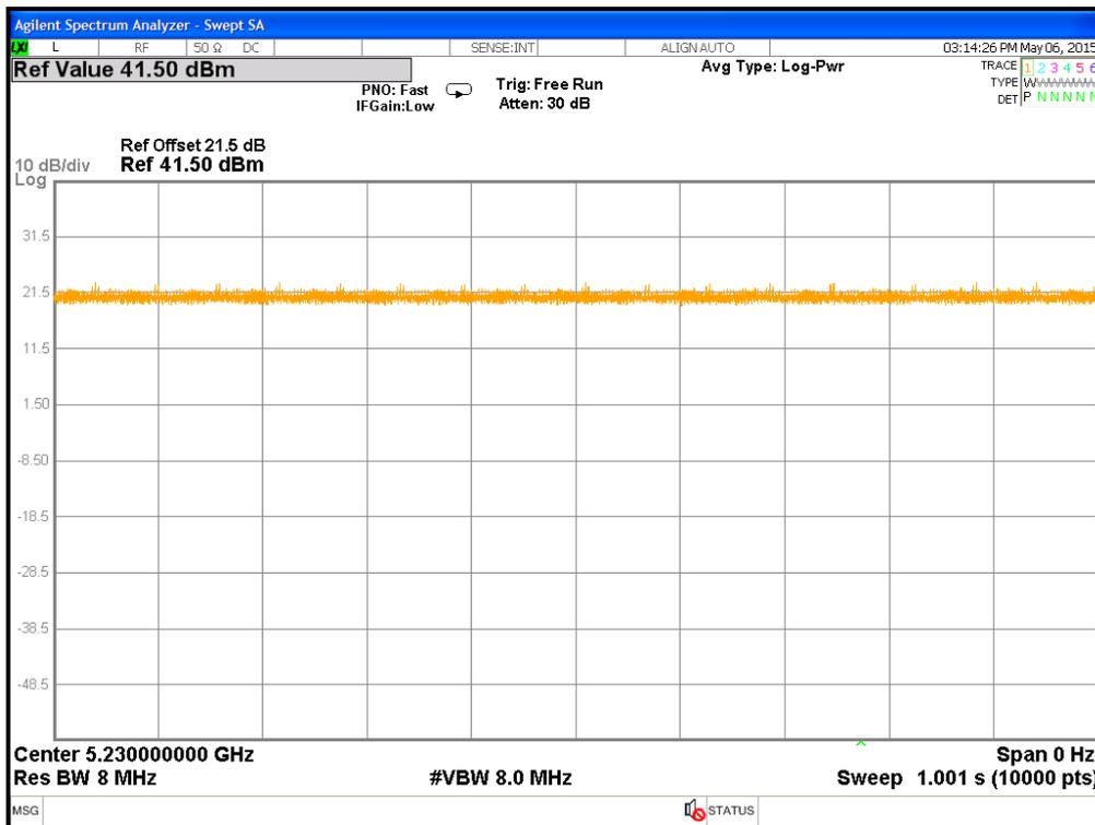
Duty Cycle @ 802.11ac(VHT80) mode Ch 42
