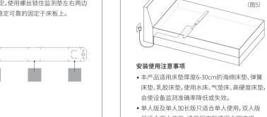
• 单人版及单人加长版只适合单人使用,双人版 只适合双人使用,请根据实际情况合理选择, • 产品需要平整稳定的固定于硬质床架(床板)上, 设备和硬质床板间可以有适当软质材料(如软
