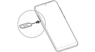
2. Saca la bandeja de la tarjeta y coloca la tarjeta nano-SIM y la tarjeta microSDXC (opcional) en la bandeja como se indica. Desliza con cuidado la bandeja para volver a colocarla en su lugar.
