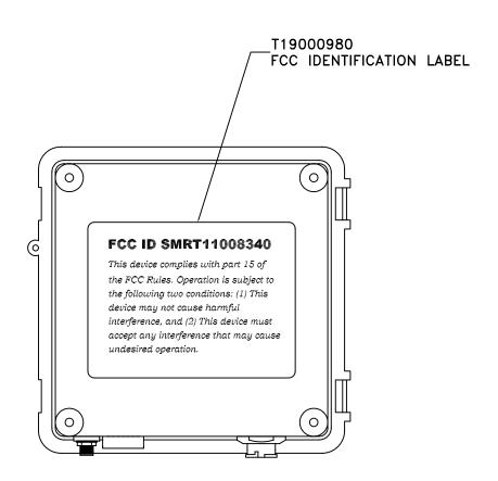
1. INSTALL FCC IDENTIFICATION LABEL (T19000980) CENTERED ON THE BACK OF THE CASE AS SHOWN ABOVE.
