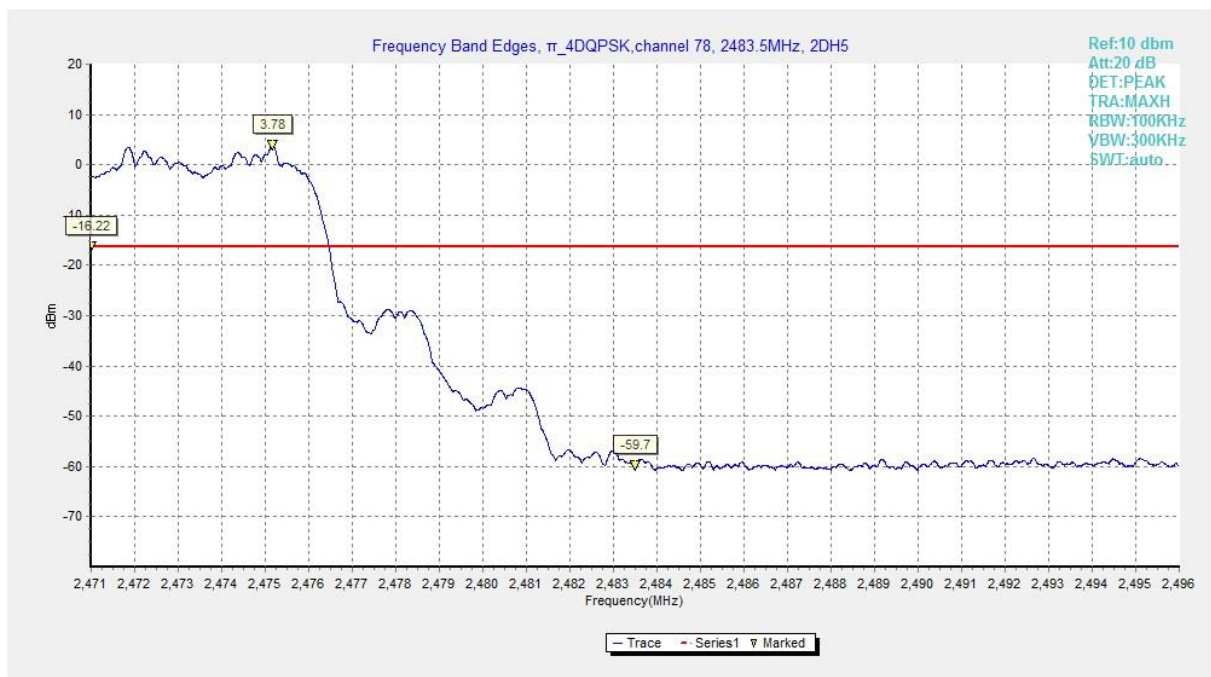
Fig. 4 Band Edges ( \pi/4 DQPSK, Ch 78, Hopping ON)
