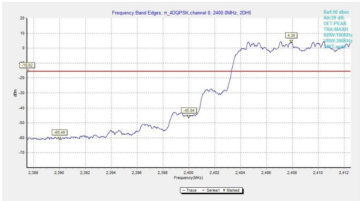
Fig. 3 Band Edges ( \pi/4 DQPSK, Ch 0, Hopping ON)
