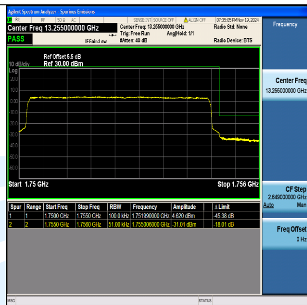
Band4 5MHz QPSK 20375 25RB#0
