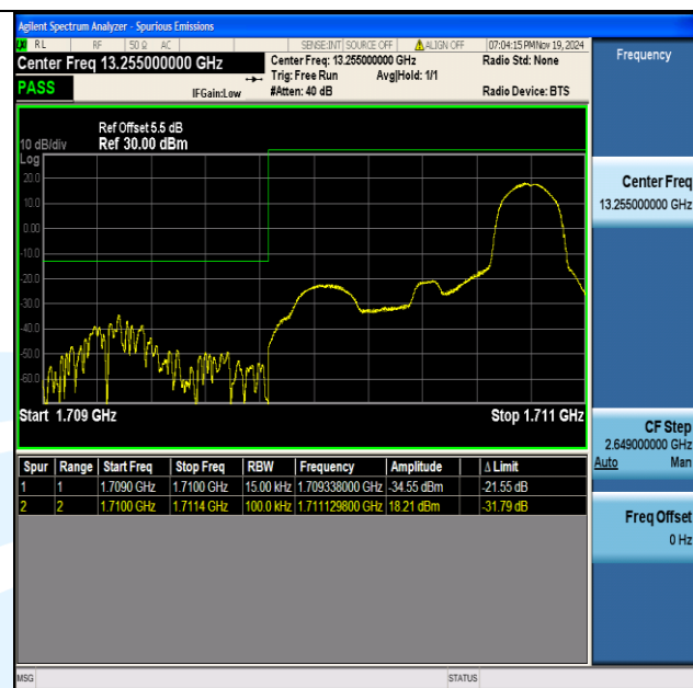
Band4 1.4MHz QPSK 19957 1RB#5
