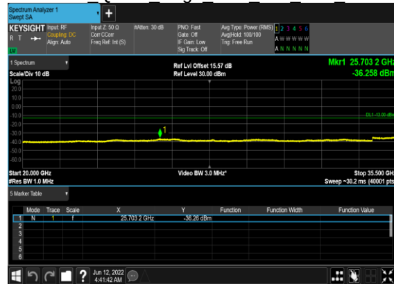
N78(60M)_DFT-s-OFDM QPSK Edge 1RB Left Low CH
