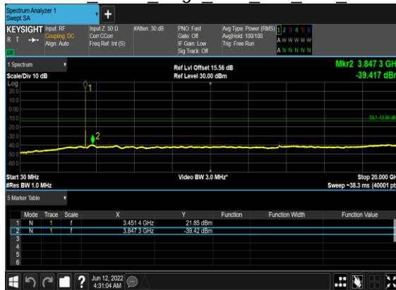
N78(20M)_DFT-s-OFDM BPSK Edge 1RB Left Low CH
