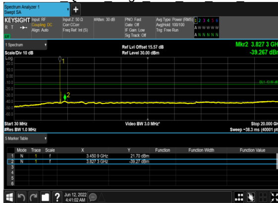
N78(60M)_DFT-s-OFDM QPSK Edge 1RB Left Low CH
