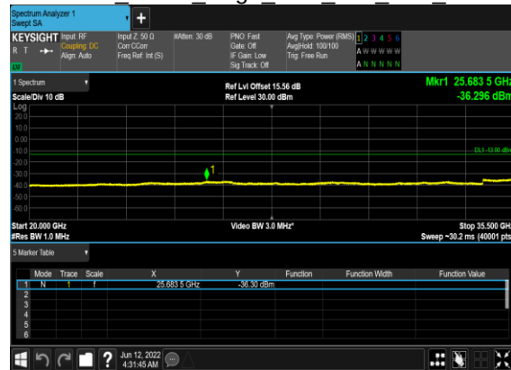
N78(20M)_DFT-s-OFDM BPSK Edge 1RB Left Low CH
