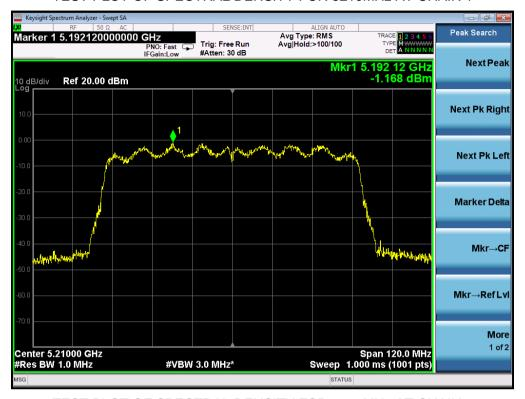
TEST PLOT OF SPECTRAL DENSITY FOR 5210MHz AT CHAIN 2
