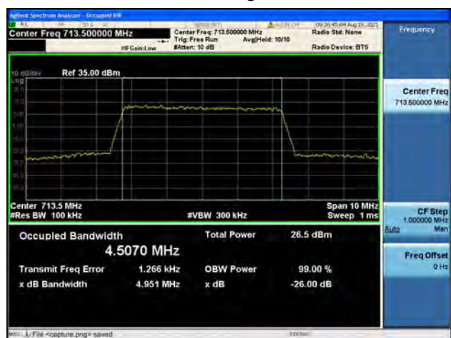
Band12 / 10MHz / Low CH / 16QAM
