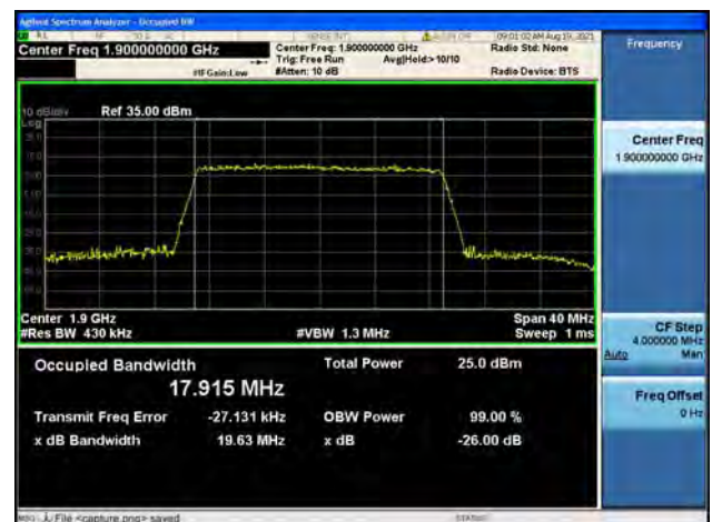
Band2 / 20MHz / High CH / 64QAM
