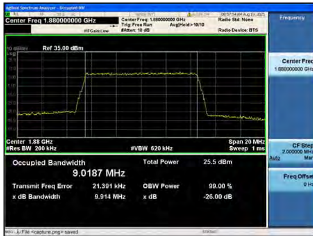
Band2 / 10MHz / Mid CH / 64QAM
