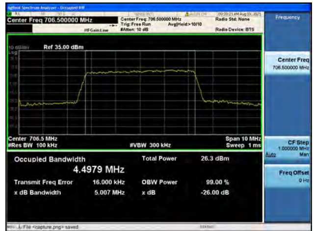
Band17 / 5MHz / Mid CH / QPSK
