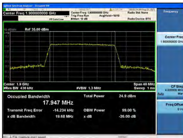
Band2 / 20MHz / High CH / 16QAM
