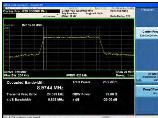
Band5 / 10MHz / Low CH / 16QAM
