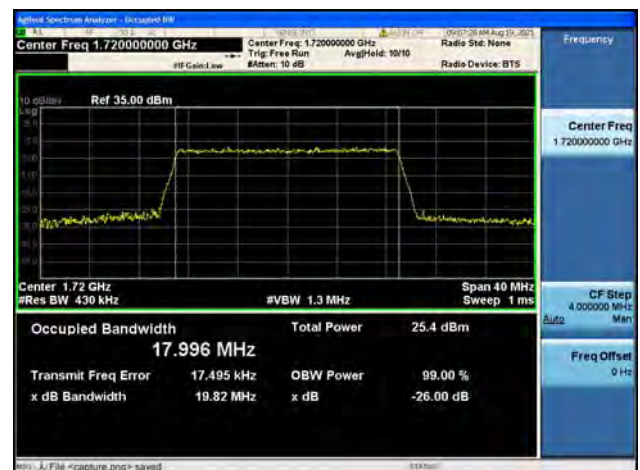
Band4 / 20MHz / Low CH / 64QAM
