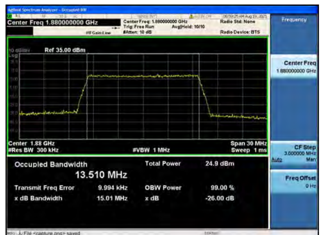
Band2 / 15MHz / Mid CH / 64QAM
