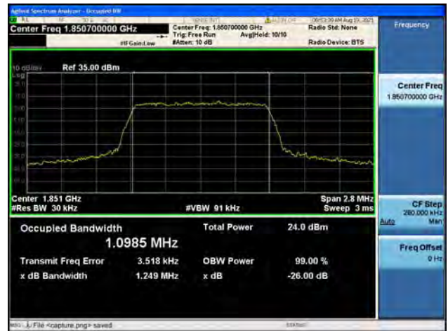
Band2 / 1.4MHz / Mid CH / QPSK
