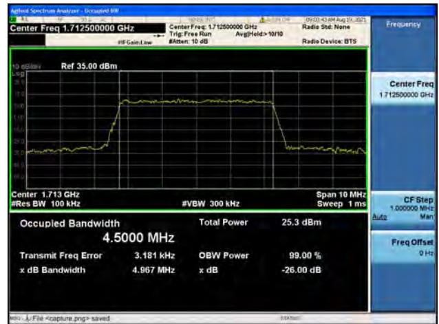
Band4 / 5MHz / Mid CH / QPSK
