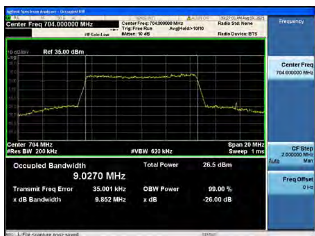
Band12 / 10MHz / Low CH / 16QAM
