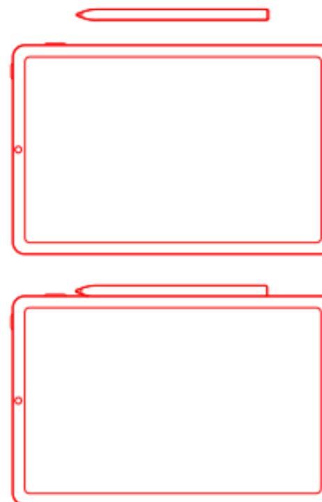
タッチペン本体をタブレットの長いサイドの中央に水平に取り付けて（図を参照）、Bluetooth のペアリングと充電を開始してください。
