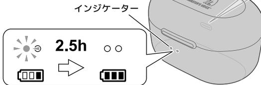
・故障や異常発熱の原因となりますので、USB 変換 AC アダプター(市販品)は、必ず出力電圧が DC5V で、電流が 1A 以上のものを使用してください。
