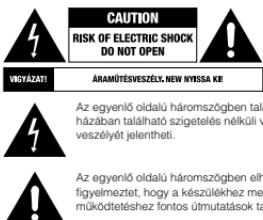
Az egyenlő oldali háromszögben található villám a készülék házánban található szigetelés nélküli vezetékre utal, ami áramütés veszélyét jelenthet.
