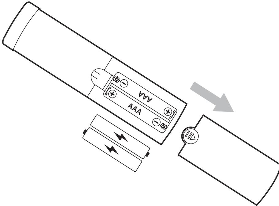
1. Retire la tapa del compartimiento de la batería.
