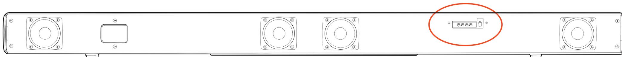
La pantalla LED de estado se encuentra en la parte frontal de la barra de sonido, dentro de un círculo aquí.
