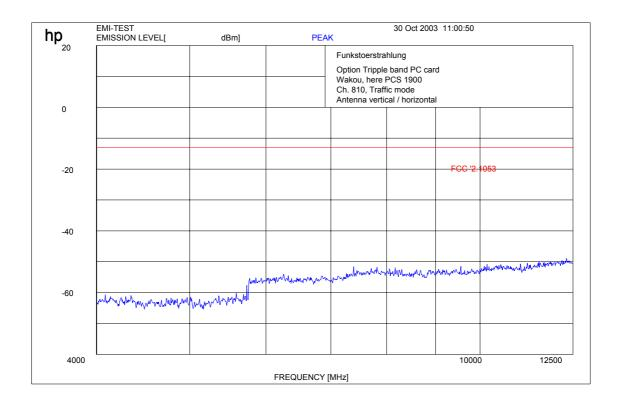
f < 1 GHz: RBW/VBW: 100 kHz  $f \ge 1 \text{GHz}$ : RBW/VBW 1 MHz
