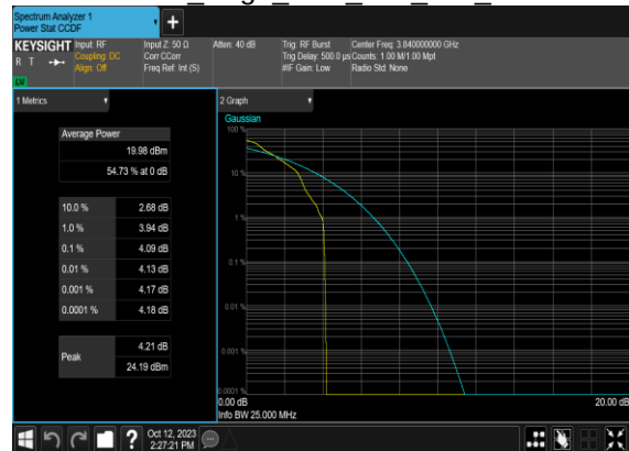
N77(20M)_DFT-s-OFDM_PI_2-BPSK Edge 1RB Left Mid CH
