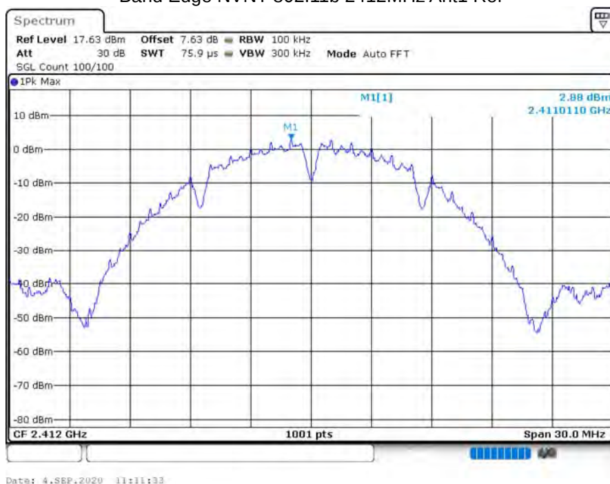
Band Edge NVNT 802.11b 2412MHz Ant1 Ref
