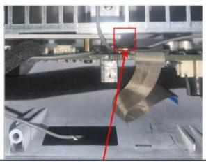
WiFi模块上方区域贴导电泡棉跟金属散热片接地
