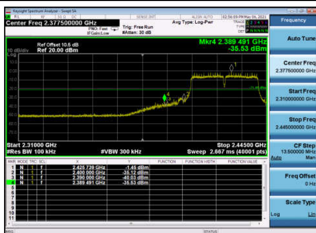
,Plot 2,Band Edge-802.11n(HT40) ,2452MHz,Ant0
