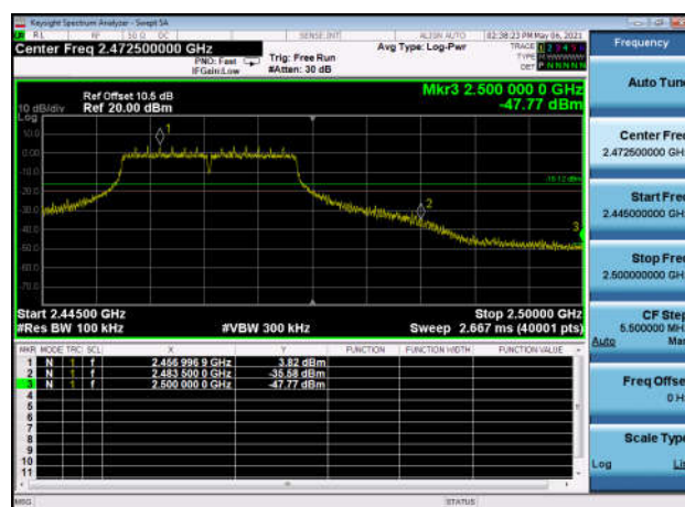
,Plot 2,Band Edge-802.11n(HT20) ,2462MHz,Ant0
