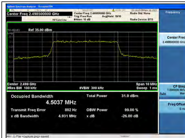
Band41 / 5MHz / QPSK/ Low CH
