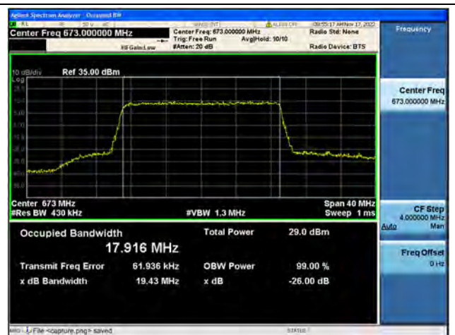
Band71 / 20MHz / 64QAM/ Low CH
