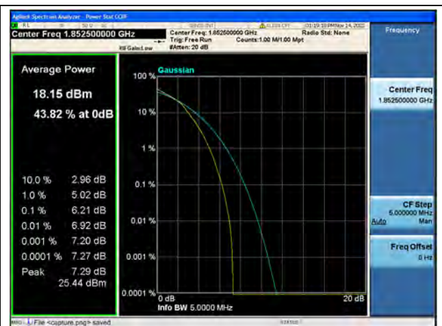
Band2 / 5MHz / Low CH / 16QAM
