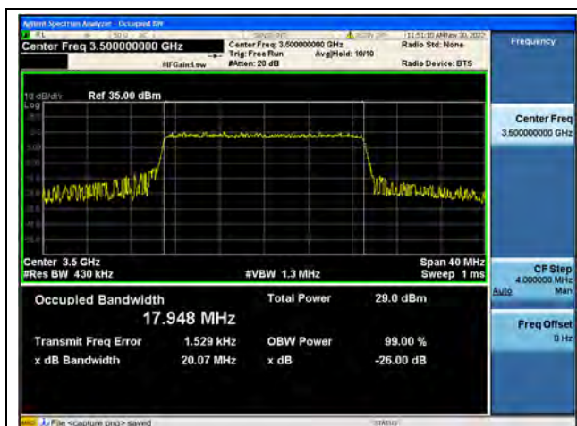
Band42 / 20MHz / QPSK/ Mid CH
