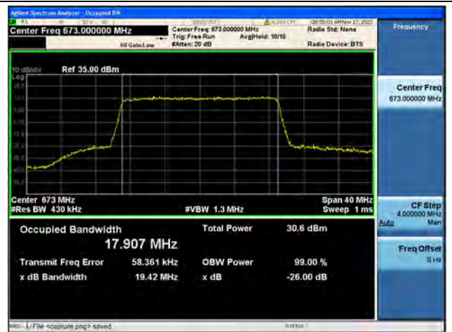
Band71 / 20MHz / QPSK/ Low CH
