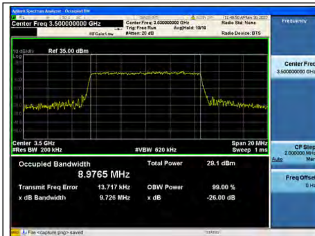
Band42 / 10MHz / QPSK/ Mid CH
