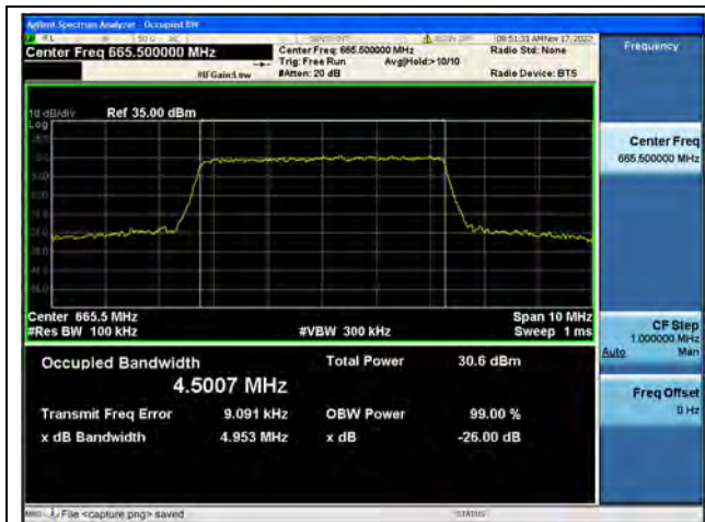
Band71 / 5MHz / QPSK/ Low CH
