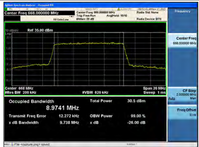
Band71 / 10MHz / QPSK/ Low CH
