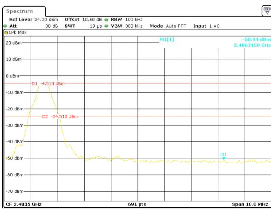
**EDR ( $\pi/4$ -DQPSK): Band Edge-Left Side**
