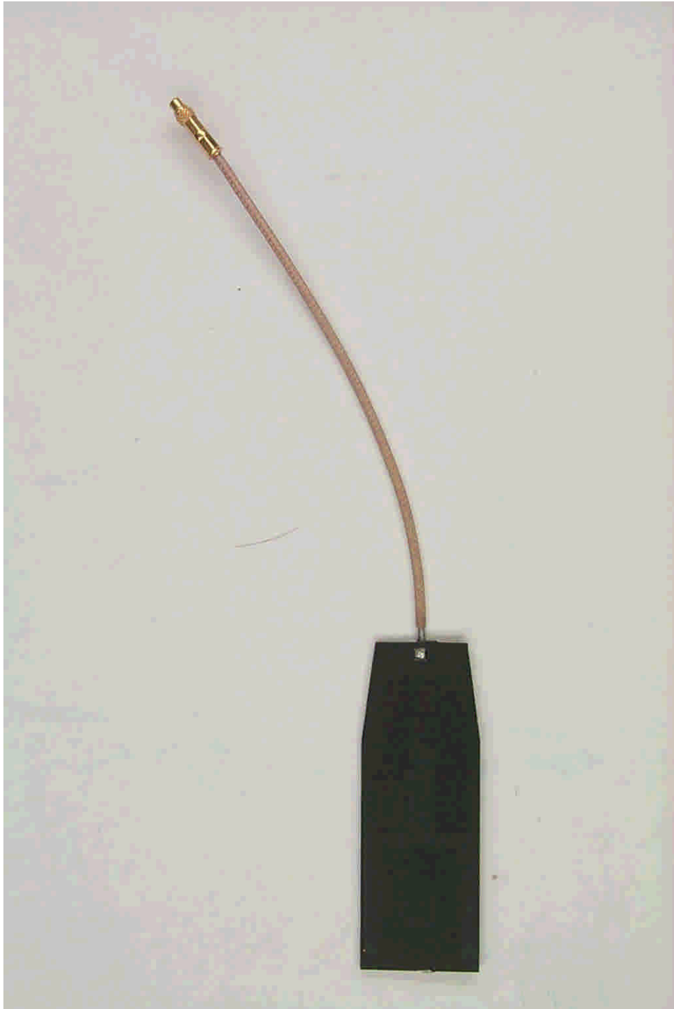
30764TX_pcb9.jpg EUT (Antenna-module) internal view
