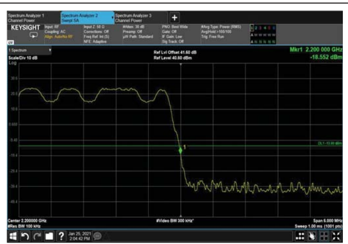
Figure 148: QPSK 5MHz B.W.; 2197.5MHz, 15kHz Upper Edge
