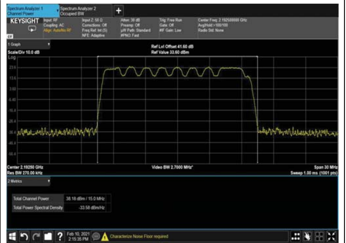
Figure 80: QPSK 15MHz B.W; 2192.5MHz, 30kHz
