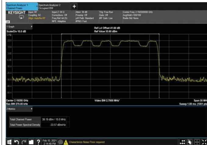
Figure 79: QPSK 15MHz B.W; 2192.5MHz, 15kHz
