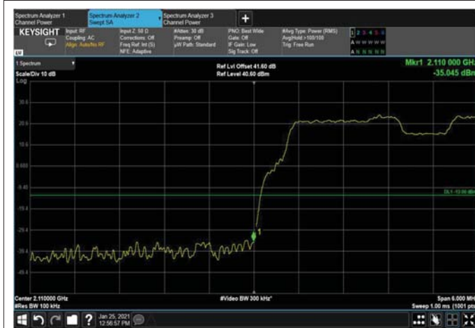
Figure 149: QPSK 5MHz B.W.; 2112.5MHz, 30kHz Lower Edge
