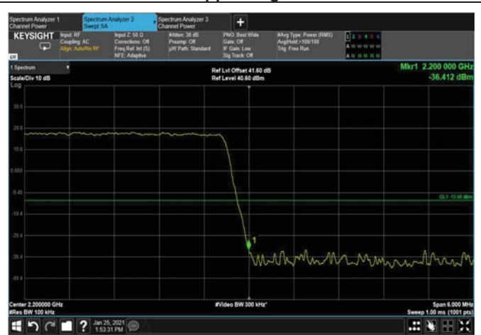
Figure 140: 256QAM 10MHz B.W.; 2195MHz, 15kHz Upper Edge
