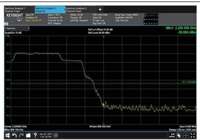
Figure 154: QPSK 10MHz B.W.; 2195MHz, 30kHz Upper Edge
