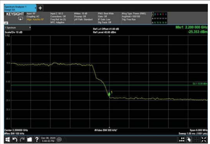
Figure 162: 16QAM 10MHz B.W.; 2195MHz Upper Edge – 4G
