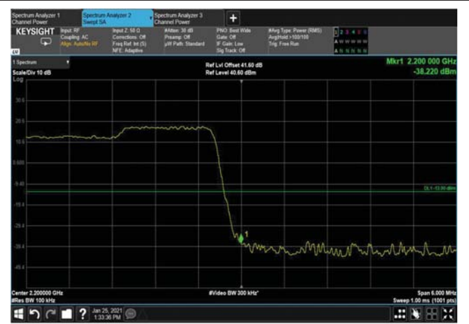
Figure 120: 16QAM 15MHz B.W.; 2192.5MHz, 15kHz Upper Edge
