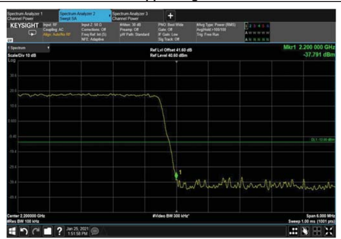
Figure 128: 64QAM 10MHz B.W.; 2195MHz, 15kHz Upper Edge
