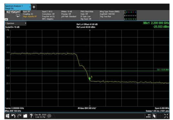
Figure 174: QPSK 10MHz B.W.; 2195MHz Upper Edge – 4G
