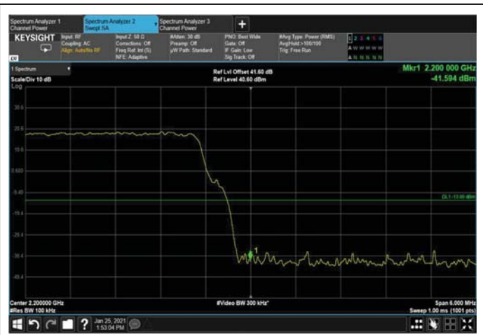
Figure 142: 256QAM 10MHz B.W.; 2195MHz, 30kHz Upper Edge
