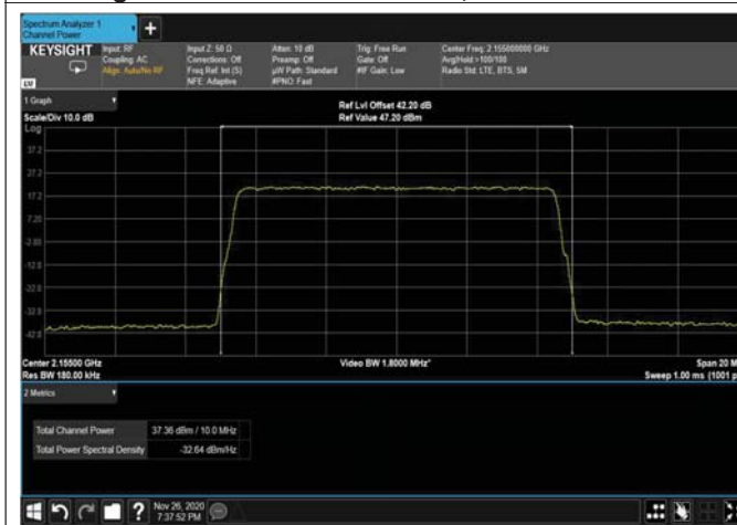
Figure 106: QPSK 10MHz; 2155MHz – 4G
