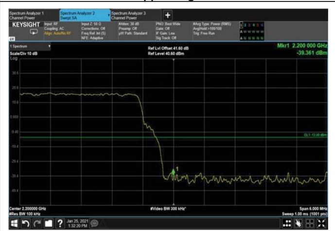
Figure 146: 256QAM 15MHz B.W.; 2192.5MHz, 30kHz Upper Edge
