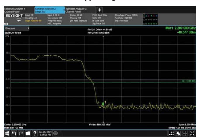
Figure 122: 16QAM 15MHz B.W.; 2192.5MHz, 30kHz Upper Edge
