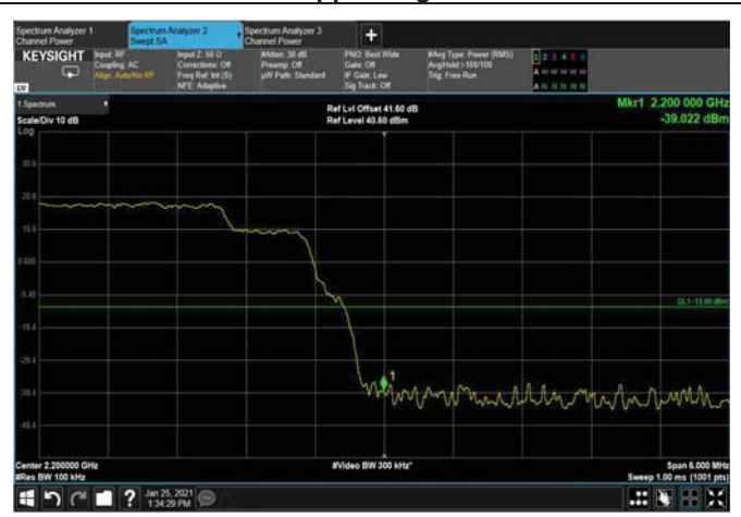
Figure 158: QPSK 15MHz B.W.; 2192.5MHz, 30kHz Upper Edge
