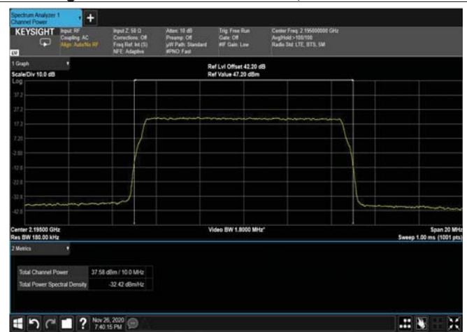
Figure 107: QPSK 10MHz; 2195MHz – 4G
