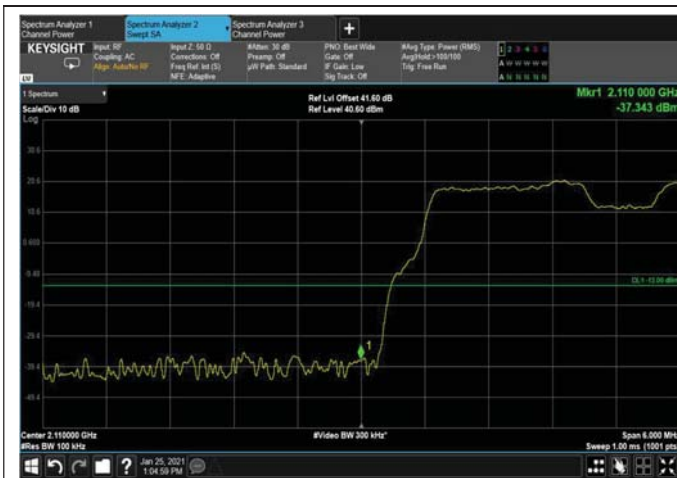
Figure 153: QPSK 10MHz B.W.; 2115MHz, 30kHz Lower Edge
