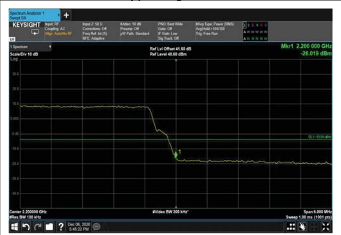
Figure 168: 64QAM 10MHz B.W.; 2195MHz Upper Edge – 4G
