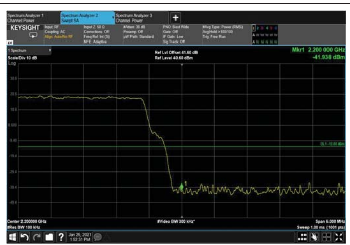
Figure 130: 64QAM 10MHz B.W.; 2195MHz, 30kHz Upper Edge
