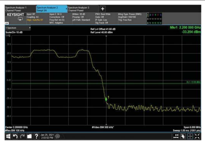
Figure 150: QPSK 5MHz B.W.; 2197.5MHz, 30kHz Upper Edge
