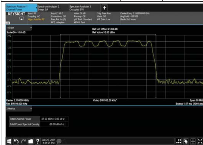
Figure 65: QPSK 5MHz B.W; 2155.0MHz, 15kHz
