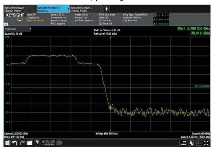
Figure 152: QPSK 10MHz B.W.; 2195MHz, 15kHz Upper Edge
