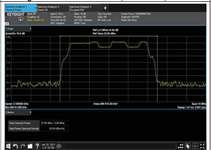
Figure 66: QPSK 5MHz B.W; 2155.0MHz, 30kHz
