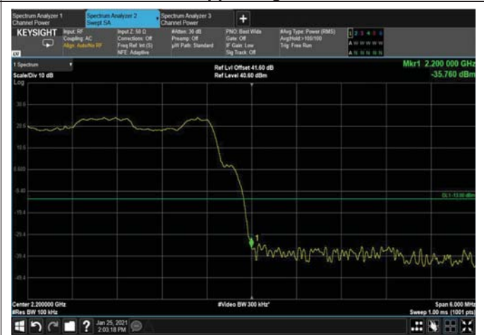
Figure 114: 16QAM 5MHz B.W.; 2197.5MHz, 30kHz Upper Edge
