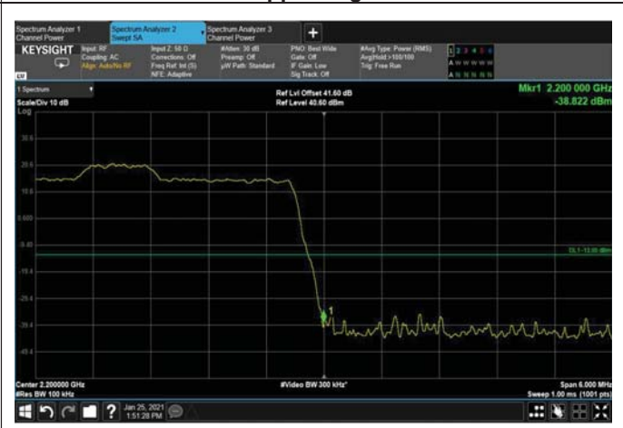
Figure 116: 16QAM 10MHz B.W.; 2195MHz, 15kHz Upper Edge
