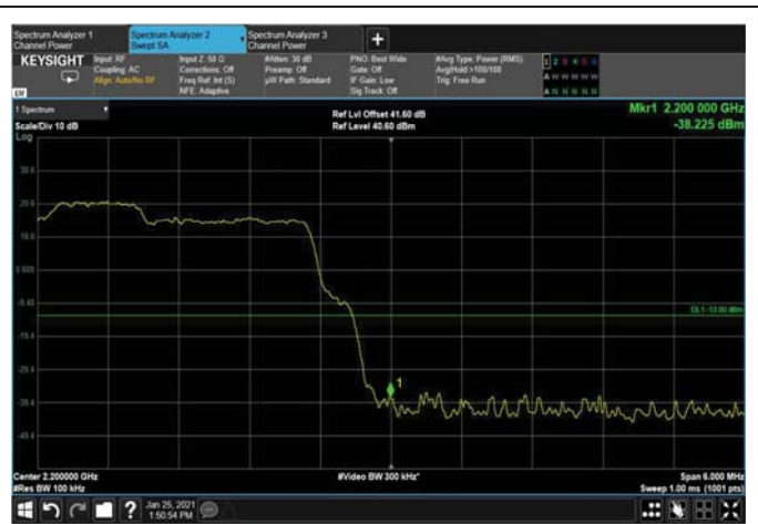
Figure 118: 16QAM 10MHz B.W.; 2195MHz, 30kHz Upper Edge
