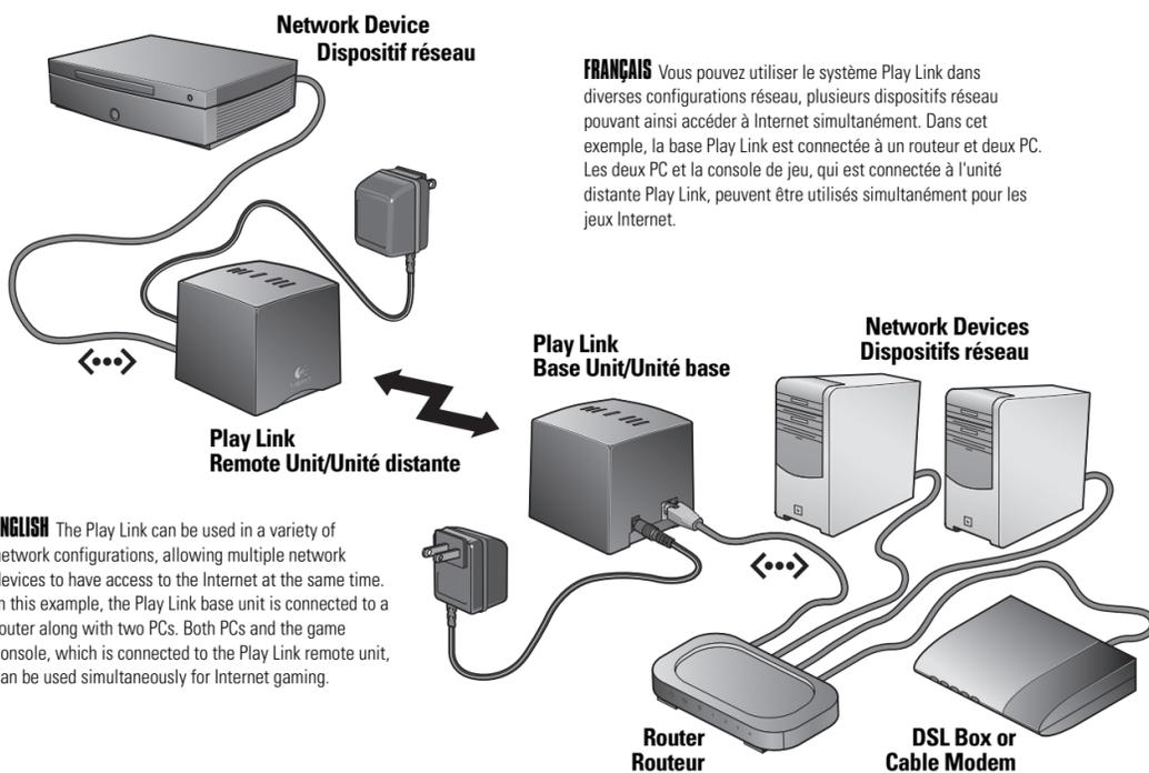
**FRANÇAIS** Vous pouvez utiliser le système Play Link dans diverses configurations réseau, plusieurs dispositifs réseau pouvant ainsi accéder à Internet simultanément. Dans cet exemple, la base Play Link est connectée à un routeur et deux PC. Les deux PC et la console de jeu, qui est connectée à l'unité distante Play Link, peuvent être utilisés simultanément pour les jeux Internet.
