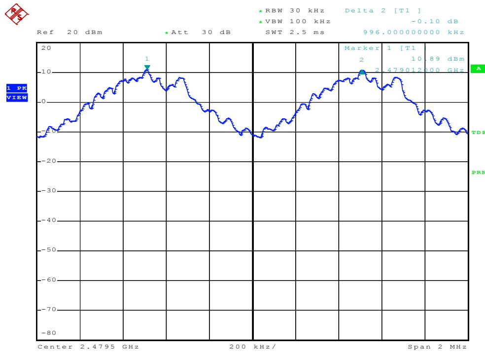
Modulation Standard:  $\pi/4$ -DQPSK (2Mbps)
