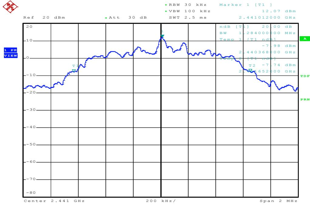
Modulation Standard:  $\pi/4$ -DQPSK (2Mbps)
