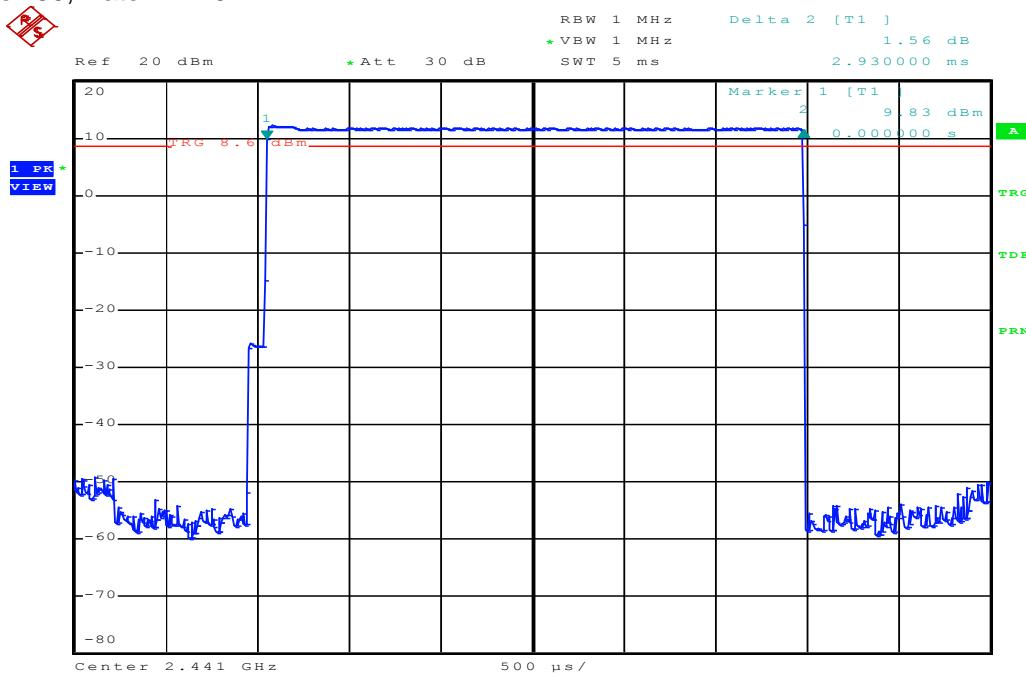
Modulation Standard:  $\pi/4$ -DQPSK (2Mbps)
