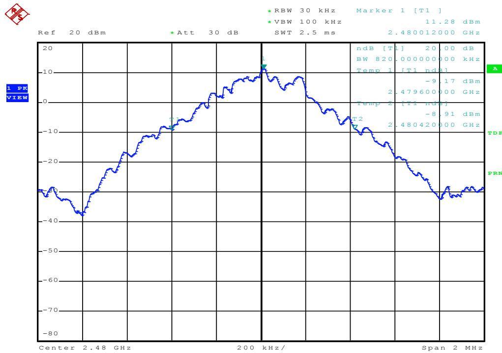
Modulation Standard:  $\pi/4$ -DQPSK (2Mbps)
