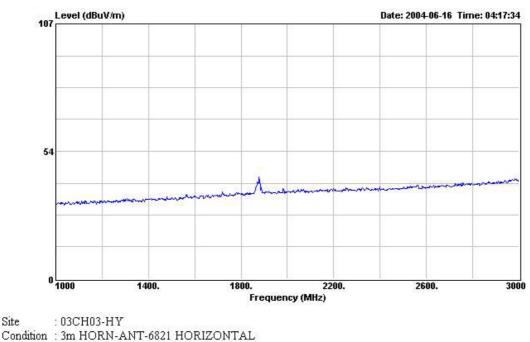
Condition : 3m HORN-ANT-6821 HORIZONTAL EUT : Tri Band 900/1800/1900 Handset Model : M100 Power : 120Vac/60Hz Memo : PCS 1900MHz CH661
