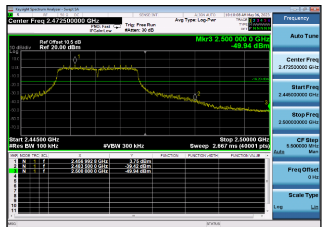
,Plot 2,Band Edge-802.11n(HT20) ,2462MHz,Ant0
