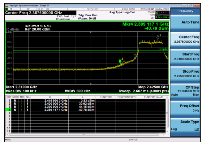
,Plot 2,Band Edge-802.11n(HT20) ,2462MHz,Ant0
