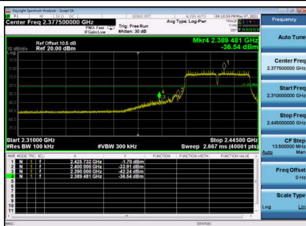
,Plot 2,Band Edge-802.11n(HT40) ,2452MHz,Ant0
