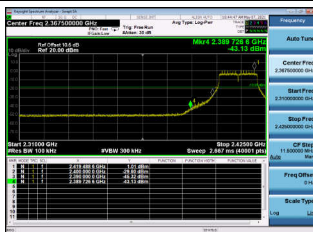
,Plot 2,Band Edge-802.11n(HT20) ,2462MHz,Ant0
