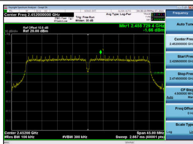
,Plot 1,Reference Level-802.11n(HT40) ,2452MHz,Ant0
