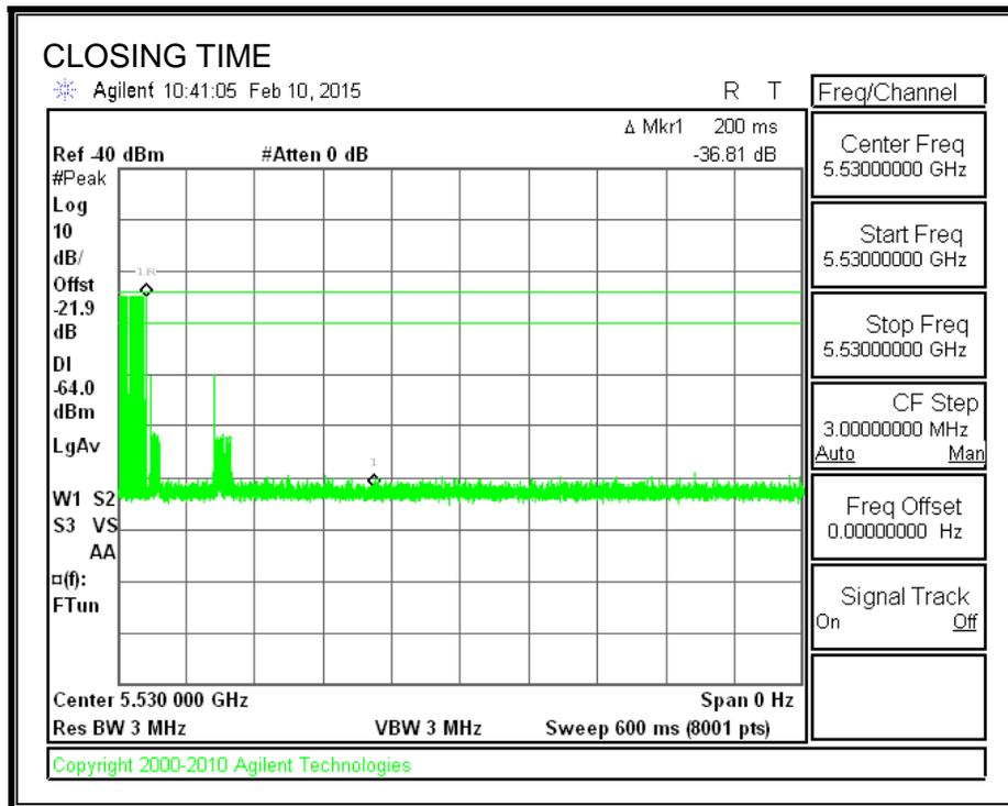
**AGGREGATE CHANNEL CLOSING TRANSMISSION TIME**
