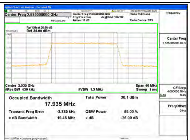
B7 / 20MHz / 16QAM/ Mid CH
