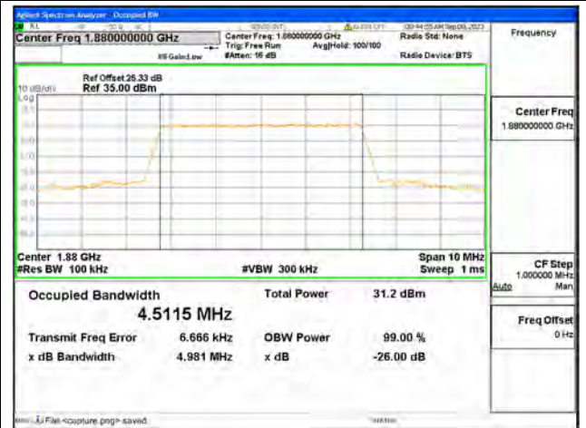
B2 / 5MHz / QPSK/ Mid CH
