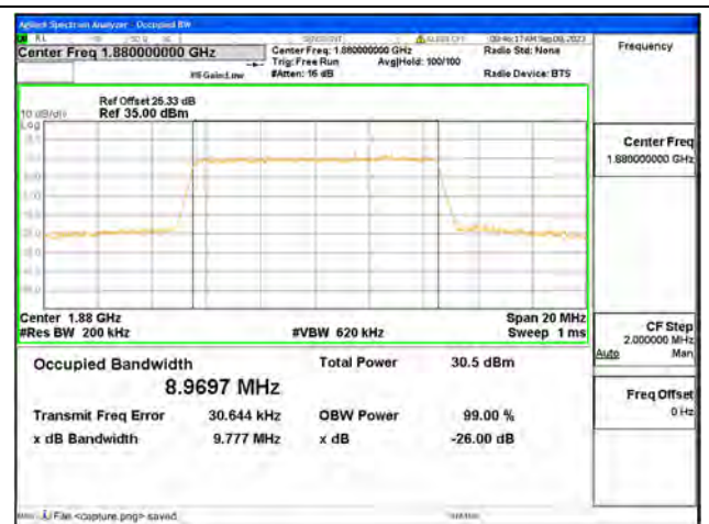
B2 / 10MHz / 16QAM/ Mid CH
