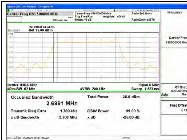
B5 / 3MHz / QPSK/ Mid CH
