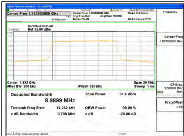
B25 / 10MHz / QPSK/ Mid CH
