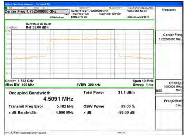
B4 / 5MHz / QPSK/ Mid CH
