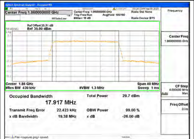
B25 / 20MHz / 64QAM/ Low CH
