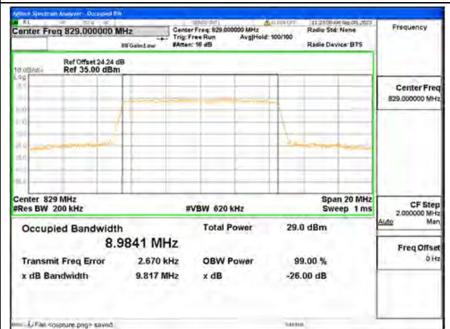
B5 / 10MHz / 64QAM/ Low CH
