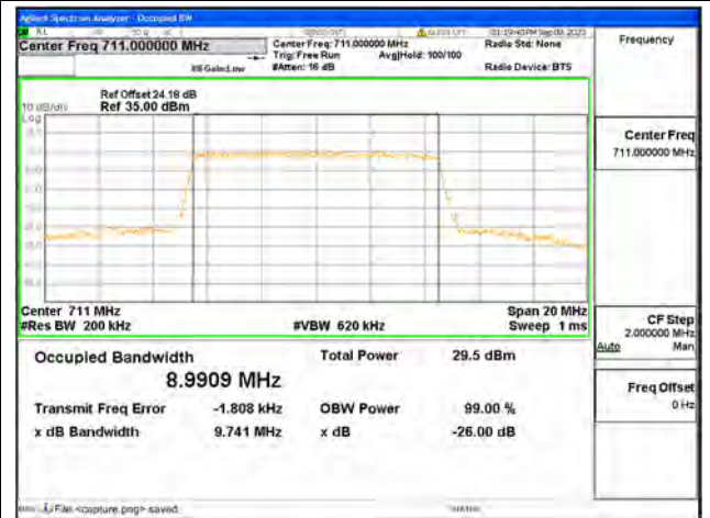
B17 / 10MHz / QPSK/ High CH
