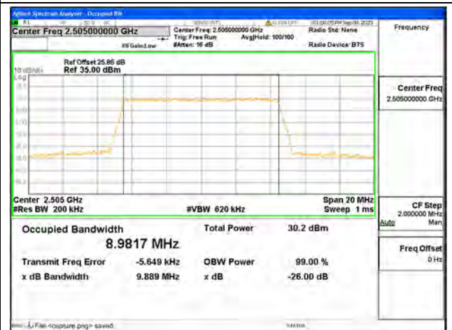
B7 / 10MHz / 64QAM/ Low CH
