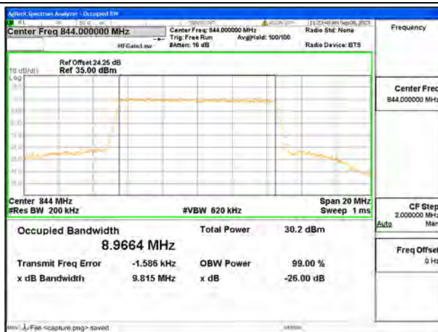
B5 / 10MHz / 16QAM/ High CH
