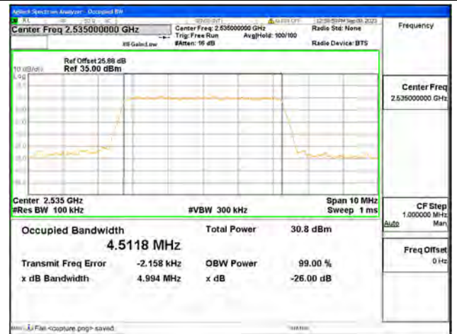
B7 / 5MHz / QPSK/ Mid CH
