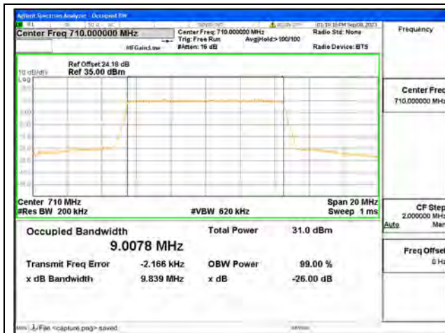
B17 / 10MHz / QPSK/ Mid CH
