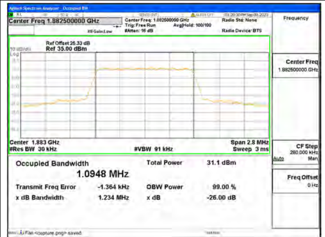
B25 / 1.4MHz / QPSK/ Mid CH
