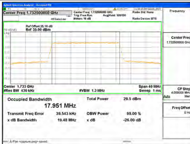
B4 / 20MHz / 64QAM/ Mid CH
