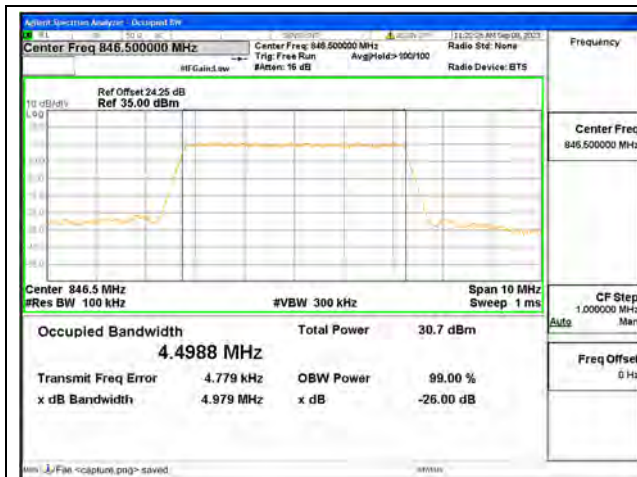
B5 / 5MHz / QPSK/ High CH
