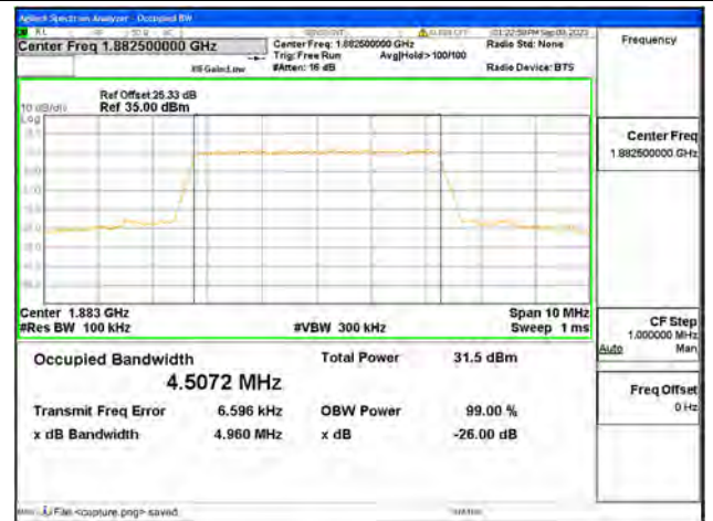
B25 / 5MHz / QPSK/ Mid CH
