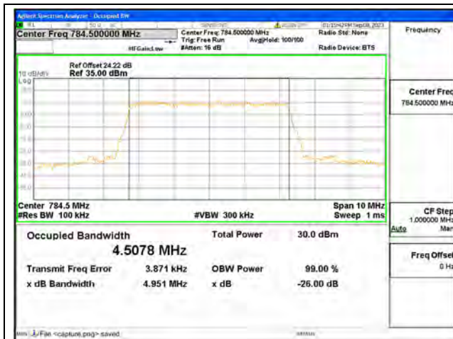
B13 / 5MHz / QPSK/ High CH
