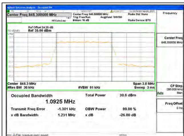
B5 / 1.4MHz / QPSK/ High CH
