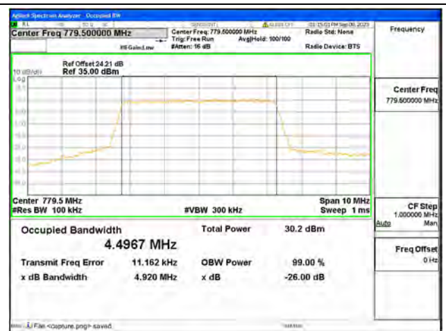
B13 / 5MHz / 16QAM/ Low CH
