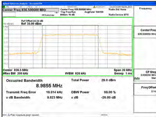
B5 / 10MHz / 64QAM/ Mid CH
