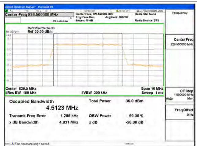
B5 / 5MHz / 16QAM/ Low CH
