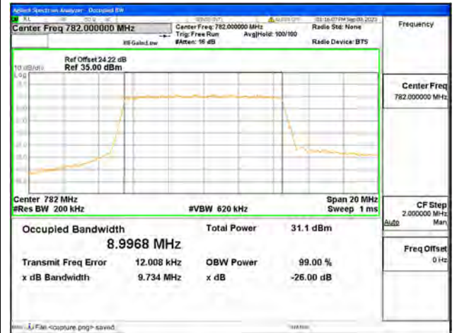
B13 / 10MHz / QPSK/ Mid CH
