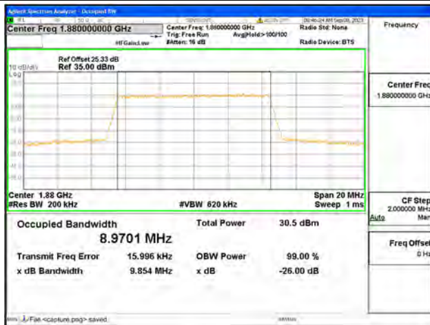
B2 / 10MHz / 64QAM/ Mid CH
