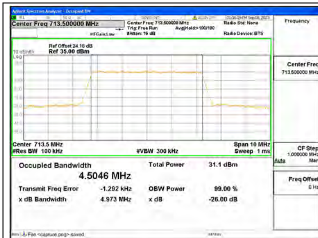
B17 / 5MHz / QPSK/ High CH
