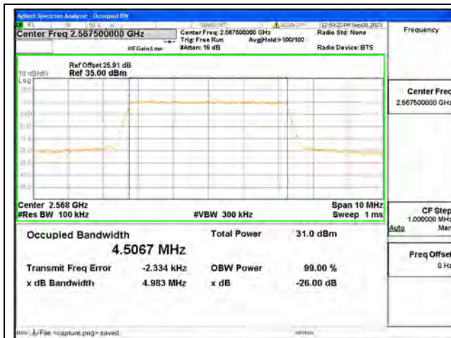
B7 / 5MHz / QPSK/ High CH
