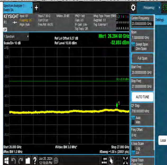
Band41 10MHz QPSK 39700 1RB#0 20000~27000 20000~27000
