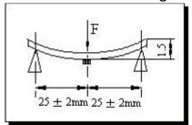
将产品按图焊在 1.6±0.2mm 的 PCB 板中间,由箭头方向施力: 1mm/S,弯曲距离: 1.5mm,保持5±1S,产品金属层无脱落。
