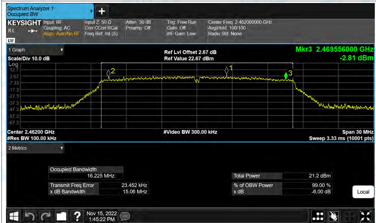
-6dB Bandwidth NVNT g 2462MHz Ant1
