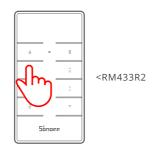
在设备上电后的5秒内长按遥控器任意按键至风扇灯蜂鸣器"滴"一声,即可配对成功,如5秒内未进行下一步操作,请重新上电。
