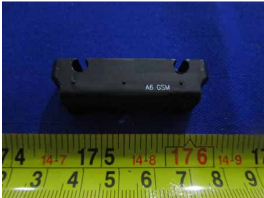
EUT –GSM & WCDMA Antenna View
