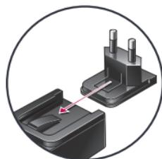
3. Pour retirer le connecteur, appuyez sur la languette et faites-le glisser hors du câble.
