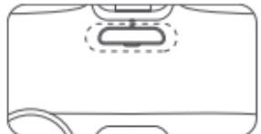
หมายเหตุ: ต้องติดสติกเกอร์ไฟฟ้าสถิตลงบนส่วนที่รับเรียบไม่ชุ่มชื้นของกระหายน้ำร้อนต์ กดให้แน่น และหลักเลี้ยงการติดลงบนขอบของพิล์มติดกระหายน้ำร้อนต์ เพื่อป้องกันไม่ให้สติกเกอร์หลุดออก
