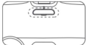
メモ: 静電シールはフロントガラスの平坦でなめらかな部分にしっかりと押し付けながら貼り付けてください。フロントガラスのフィルムの端に貼り付けると落下する危険があるので注意してください。
