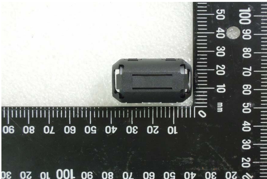
Ferrite Suppression Core
