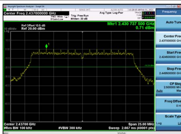
,Plot 2,Band Edge-802.11n(HT20) ,2412MHz
