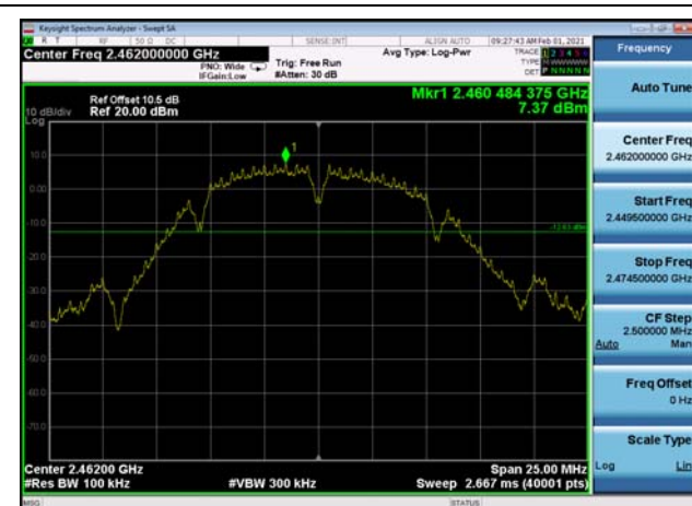
,Plot 2,Band Edge-802.11b,2437MHz
