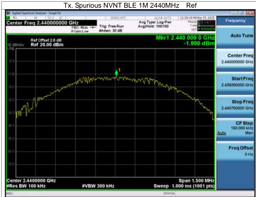
Tx. Spurious NVNT BLE 1M 2440MHz Emission
