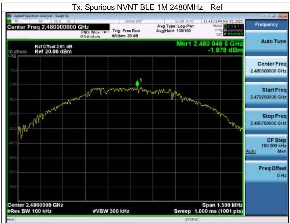
Tx. Spurious NVNT BLE 1M 2480MHz Emission
