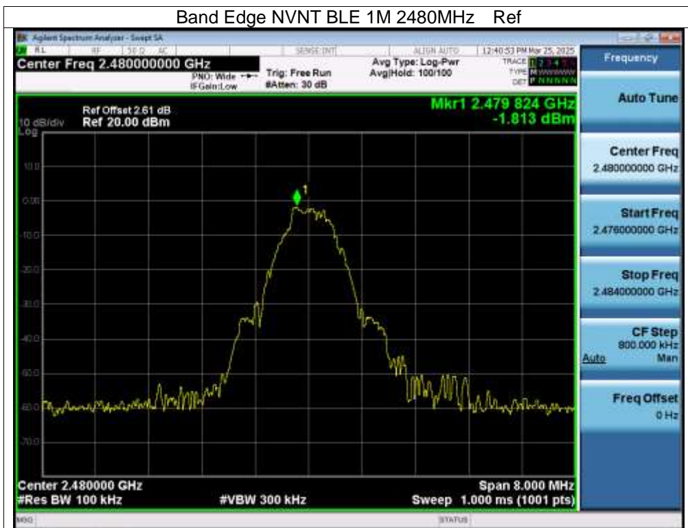
Band Edge NVNT BLE 1M 2480MHz Emission
