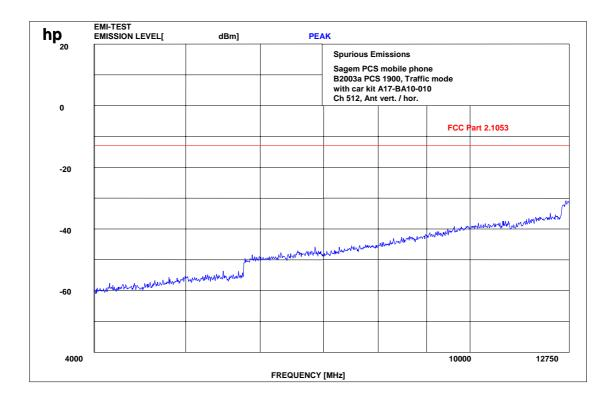
$f < 1 \; GHz : RBW/VBW : 100 \; kHz \qquad \qquad f \geq 1 GHz : RBW / VBW \; 1 \; MHz$
