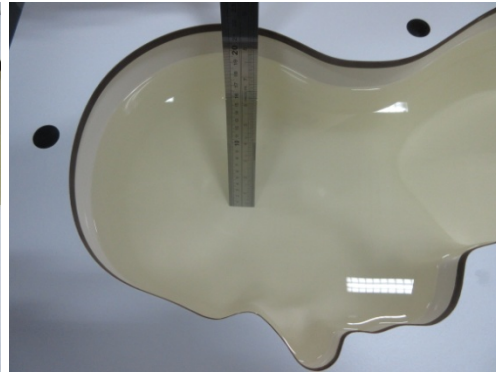
Body(1900MHz~2600 MHz) 15.5cm Head (1900MHz~2600MHz) 15.1cm
