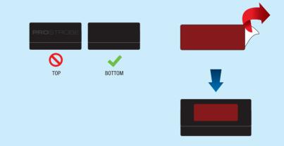
2) PEEL THE RED BACKING OFF THE ADHESIVE PAD AND PRESS CONTROL BOX FIRMLY ON TO CLEAN. SECURE LOCATION
