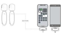
第⑧的使用方法如下:如果直播时,手机电量不足的情况下,外接电源直 接通过接收端Type-C接口给予手机充电。
