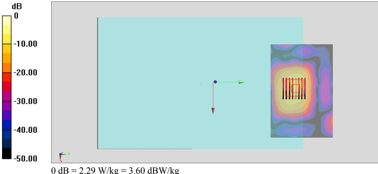
**#04\_WLAN5GHz\_802.11ac-VHT80 MCS0\_Bottom Face\_0mm\_Ch155;Ant 1**
